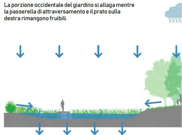
Schema di giardino umido con fitodepurazione in subalveo e sistema a flusso sommerso orizzontale che capta le acque pluviali urbane.
